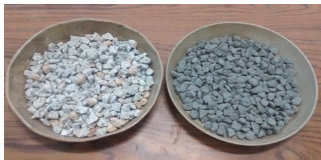
Slika 4. Neobloženi agregat i agregat obložen geopolimerom na bazi letećeg pepela
